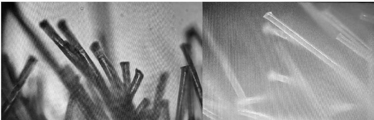
Abbildung 1 und 2 Nylon-Hohlfasern am gebrochenen Ende der Testtupfer.
